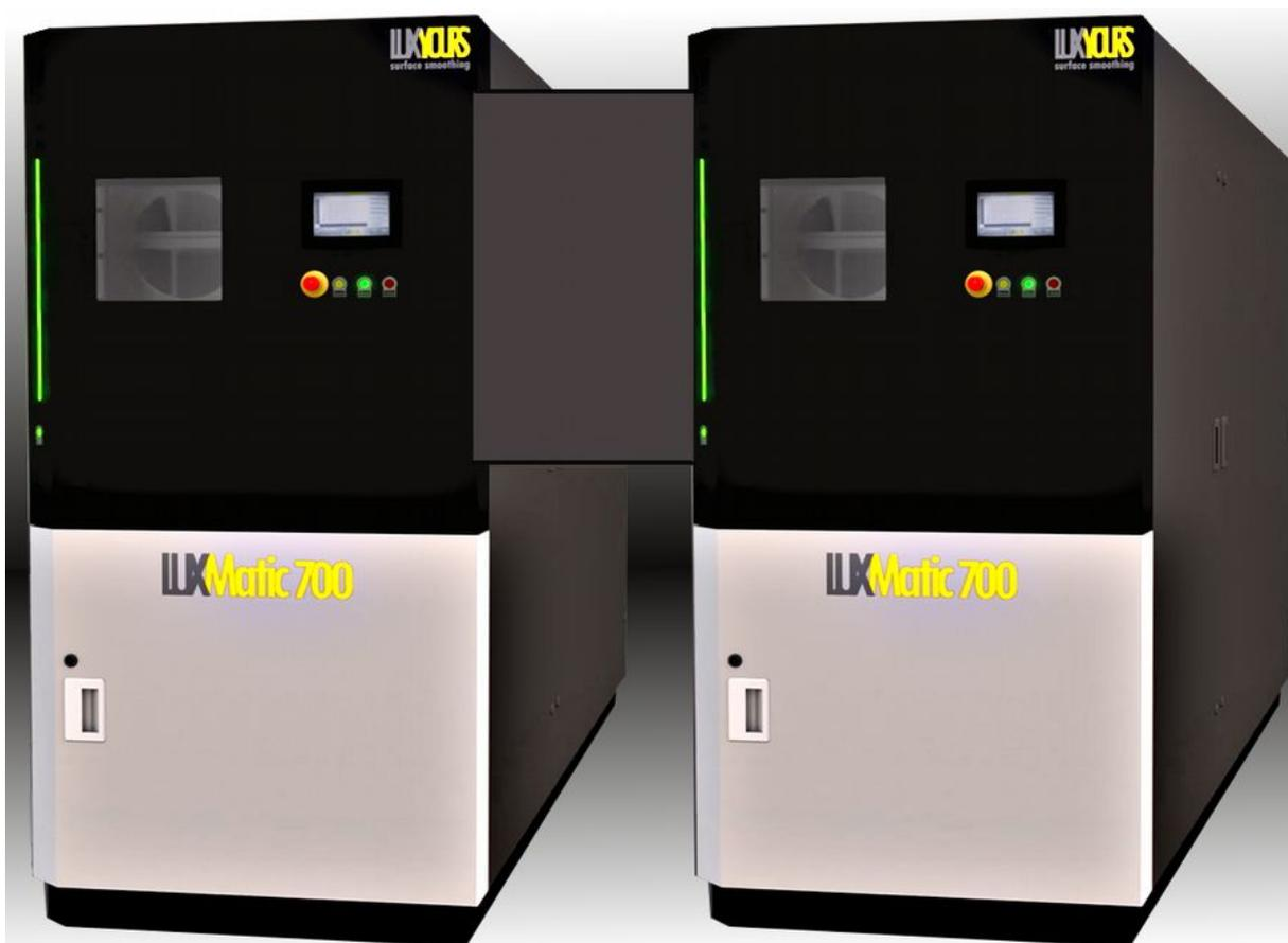
*Zwei LUXMatic 700 durch einen Tunnel gekoppelt glätten bis zu 2m lange Bauteile*
